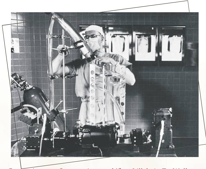
Ο πρωτότυπος οξυγονωτής φουσαλίδων Lillehei - De Wall που κατασκευάστηκε στο πανεπιστήμιο της Minnesota το 1955
